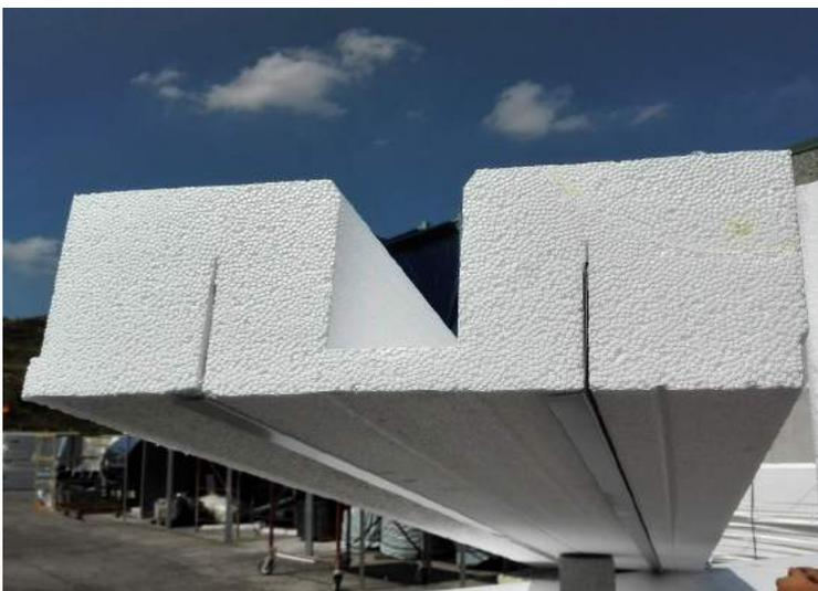
Il Pannello "SOLAIO DRY" è un cassero "a rimanere" per la realizzazione di solai a travetti monodirezionali in c.c.a. gettato in opera. Il suo impiego si pone l'obiettivo di realizzare solai alleggeriti coibentati, consentendo nel contempo una grande semplicità di posa e riducendo i tempi di costruzione.
